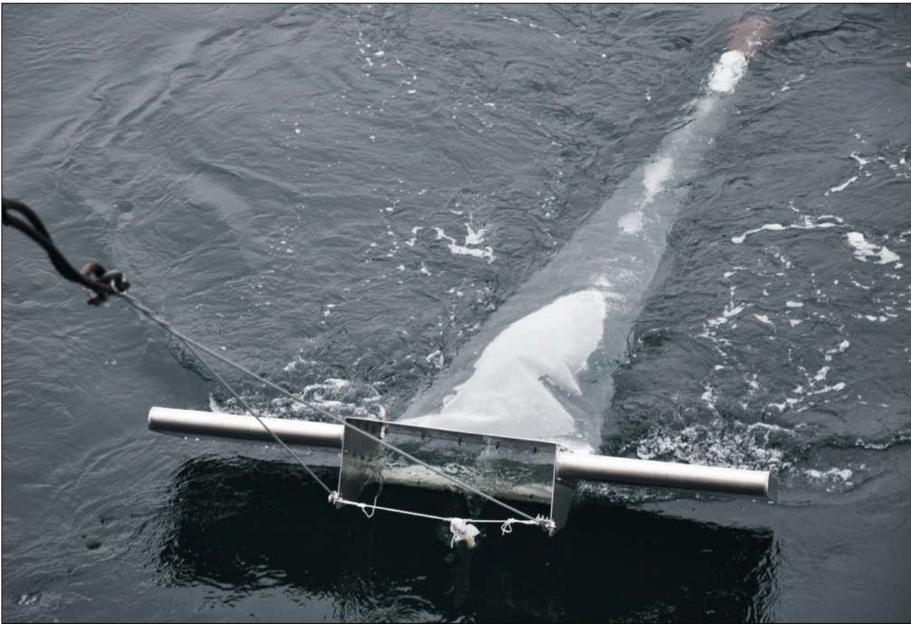
2. ábra: Mikroműanyag mintázás planktonhálózattal tengerből [52]. Figure 2: Manta net, being used to collect microplastics from surface waters [52].
